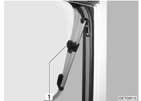
Kuva 82 Kattoluukku, jossa on kääntöpidikkeet, avattu
