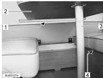
Bild 91 Hängetisch mit wechselbarem Tischfuß
