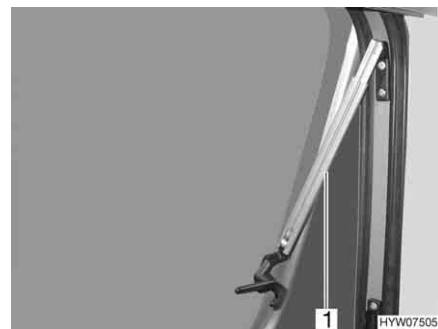
Bild 68 Ausstellfenster mit Automatik-Ausstellern, geöffnet
