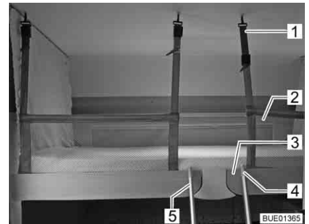
Bild 106 Hubbett mit aufgespanntem Sicherungsnetz
