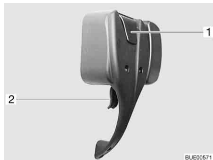
Fig. 36 Serrure de la porte cellule, à l'intérieur, verrouillée
