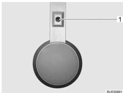
Fig. 52 Lampe, interrupteur d'éclairage directement sur la lampe
