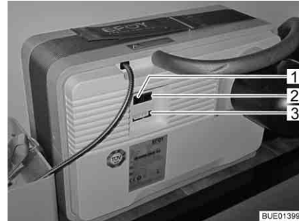
Fig. 164 Champ de raccordement de la pile à combustible
