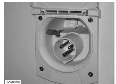
Afb. 168 230-V-aansluiting op het voertuig
