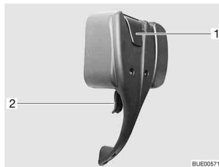
Fig. 44 Serrure de la porte cellule, à l'intérieur, verrouillée
