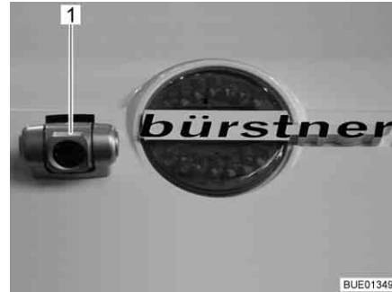
Fig. 15 Caméra de marche arrière avec éclairage à infrarouge
