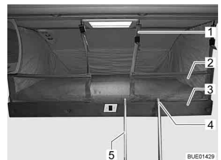
Fig. 103 Cama elevada con red de seguridad tendida
