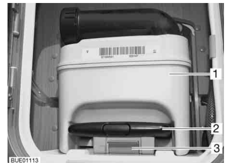
Fig. 243 Depósito de aguas fecales
