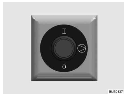
Fig. 166 Conmutador de mando de la bomba de circulación adicional (alternativa)
