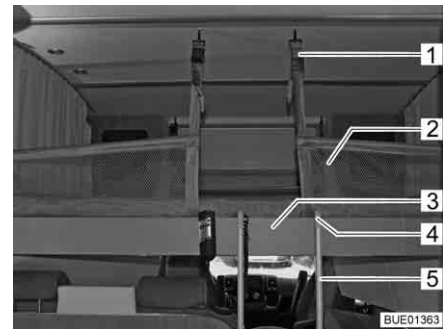
Fig. 106 Cama elevada con red de seguridad tendida
