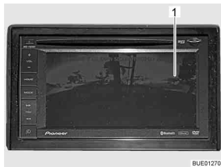
Fig. 16 Monitor LCD para la cámara de marcha atrás (ejemplo)
