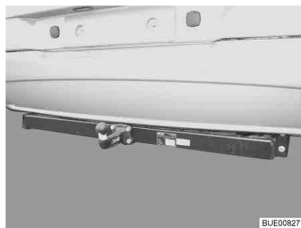
Fig. 7 Acoplamiento de remolque
