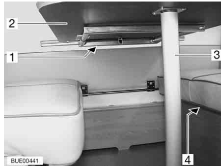
Fig. 95 Transformación en cama
