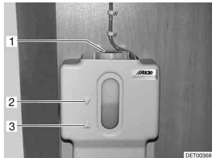
Fig. 196 Vase d'expansion pour le chauffage à eau chaude
