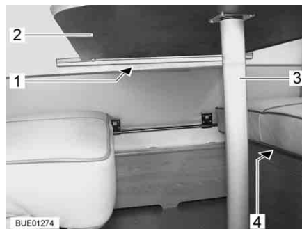
Fig. 78 Table suspendue avec pied de table amovible
