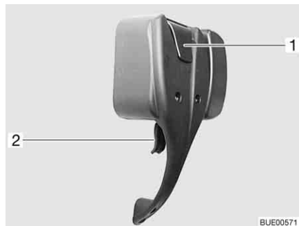
Fig. 28 Serrure de la porte cellule, à l'intérieur, verrouillée
