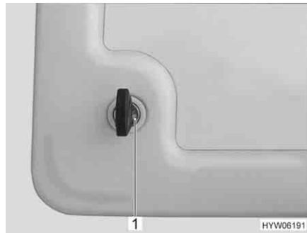
Fig. 35 Verrou de pression portillon de service
