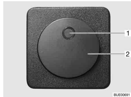
Billede 142 Kontakt for elektrisk gulvopvarmning
