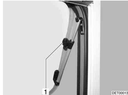
Bild 71 Överkantshängt fönster med vridspärrar, öppet
