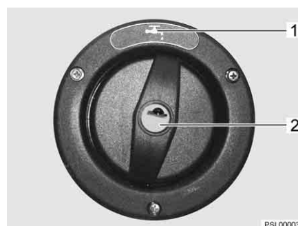
Bild 204 Lock för påfyllningsöppningen för dricksvatten (alternative)
