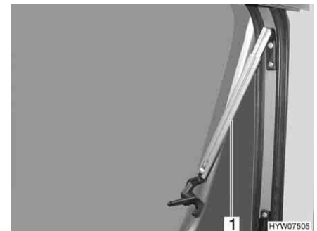
Bild 74 Överkantshängt fönster med automatik-spärr
