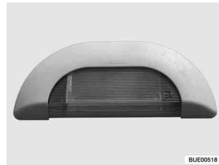
Fig. 56 Éclairage de l'auvent (partiellement équipement spécial)
