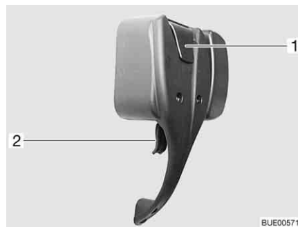
Fig. 40 Serrure de la porte cellule, à l'intérieur, verrouillée
