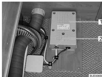
Fig. 173 Transformador para calentamiento eléctrico del piso
