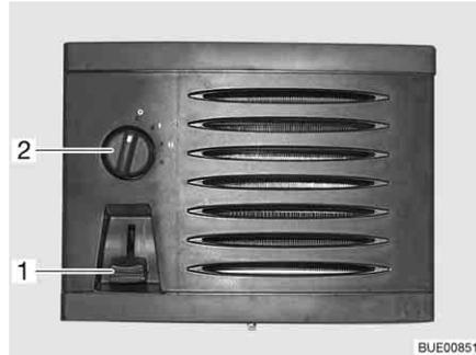
Fig. 172 Elementos de mando termo-cambiador adicional
