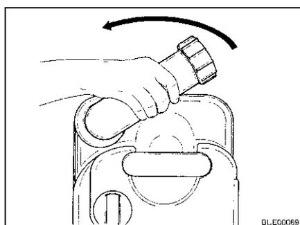
Fig. 232 Girar el tubo de vaciado
