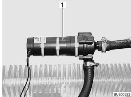
Fig. 170 Bomba de circulación adicional
