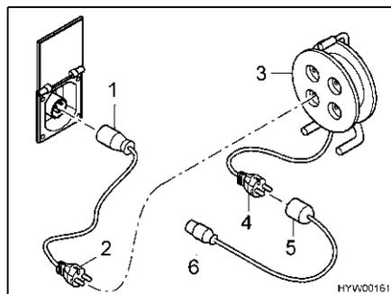
Fig. 142 Posibilidades de conexión de 230 V
