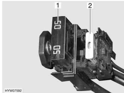
Fig. 146 Fusibles en la batería del habitáculo
