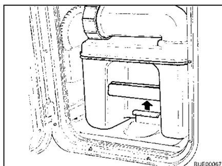
Fig. 214 Tirar del estribo de sujeción
