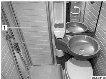
Fig. 9 Panel de separación de la ducha
