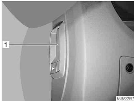
Fig. 26 Palanca de desbloqueo del capó del motor (en el vehículo)
