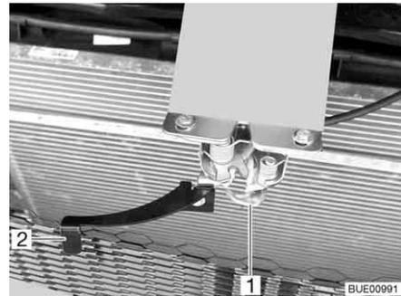
Fig. 27 Palanca de desbloqueo del capó del motor (en el exterior)
