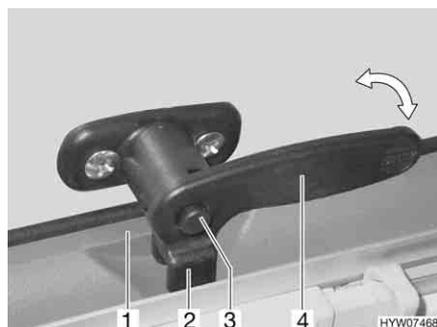
Fig. 73 La palanca de bloqueo con botón de seguridad en la posición "cerrada"
