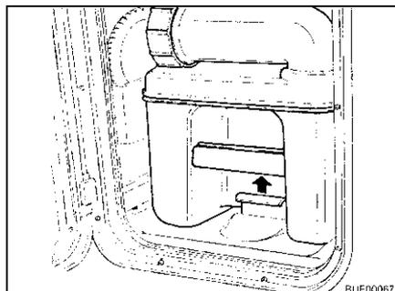
Fig. 230 Tirar del estribo de sujeción
