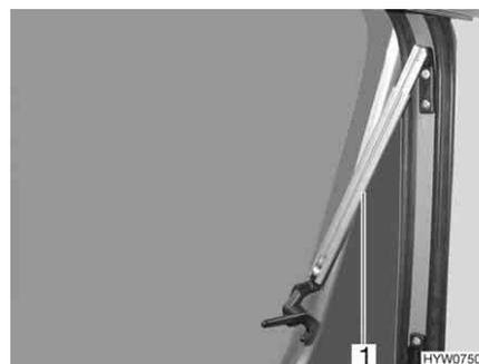
Fig. 74 Ventana abatible con soporte automático
