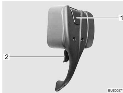
Fig. 40 Cerradura de la puerta de entrada, en el interior, bloqueada
