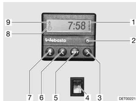
Fig. 175 Unidad de mando para la calefacción auxiliar
