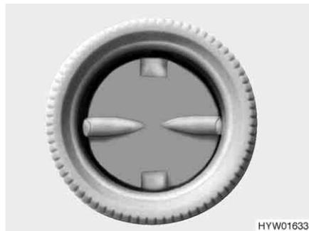
Fig. 163 Boquilla de salida de aire
