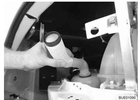
Fig. 30 Tubo de llenado en posición de llenado
