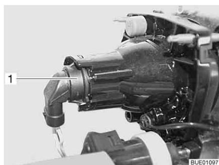
Fig. 256 Luz de cruce/luz larga/luz de estacionamiento
