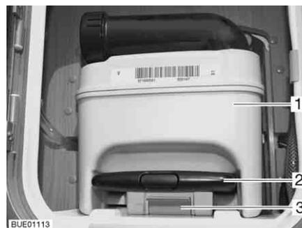
Fig. 244 Depósito de aguas fecales
