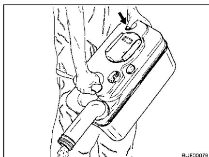
Fig. 249 Vaciar el depósito de aguas fecales
