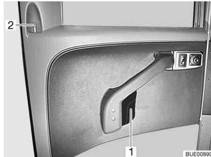
Fig. 38 Cerradura de la puerta del conductor, en el interior
