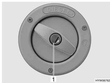
Fig. 31 Tapa de cierre para el tubo de llenado de combustible
