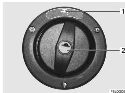
Fig. 50 Tapa de cierre para el tubo de llenado de agua potable (alternativa)
