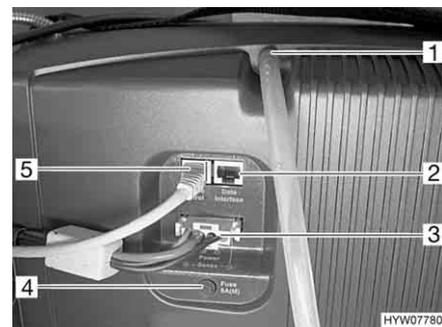
Fig. 139 Campo de conexiones de la pila de combustión
