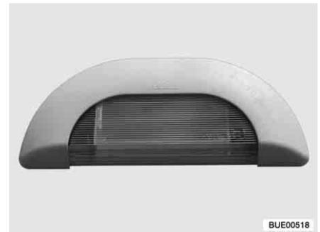
Fig. 56 Lámpara del toldo (en parte equipamiento especial)
