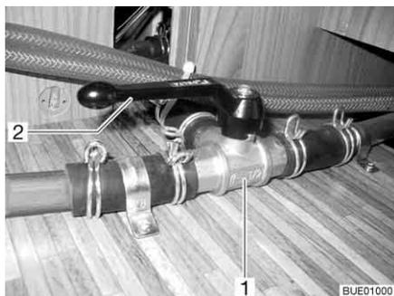
Fig. 168 Válvula de 3 vías
