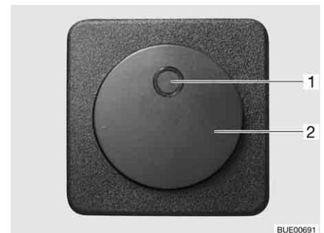
Fig. 174 Interruptor para calentamiento eléctrico del piso
