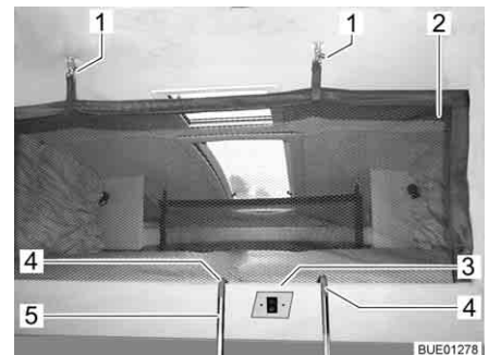
Billede 100 Hejseseng med opspændt sikkerhedsnet
