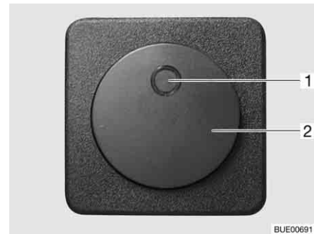
Billede 174 Kontakt for elektrisk gulvopvarmning
