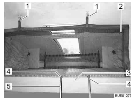
Billede 106 Hejseseng med opspændt sikkerhedsnet
