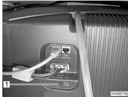
Fig. 150 Fusibile della pila a combustibile
