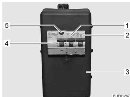
Fig. 152 Scatola dei fusibili a 230 V con interruttore di sicurezza e interruttore automatico FI
