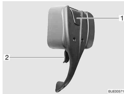
Fig. 40 Serratura della porta di ingresso, lato interno, bloccata
