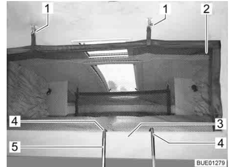
Bild 106 Hubbett mit aufgespanntem Sicherungsnetz
