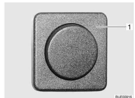
Bild 58 Toilettenraumbeleuchtung, Lichtschalter getrennt von der Leuchte
