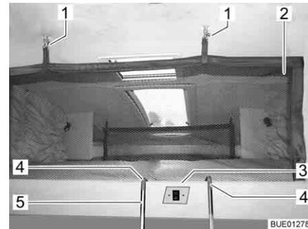
Bild 100 Hubbett mit aufgespanntem Sicherungsnetz
