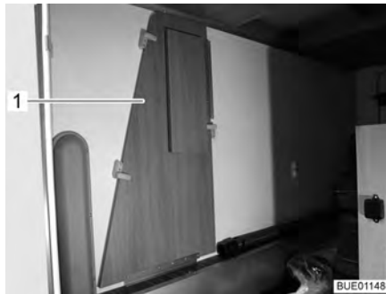
Kuva 13 Vuoteen levennys takatilassa
