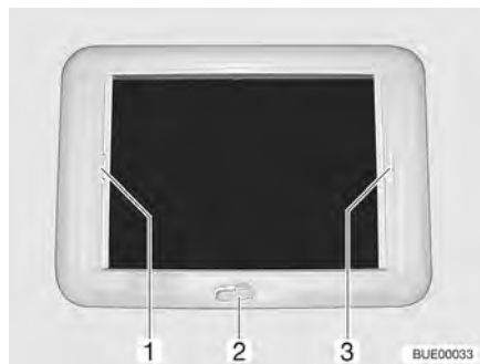
Kuva 77 Kammella nostettava kattoluukku
