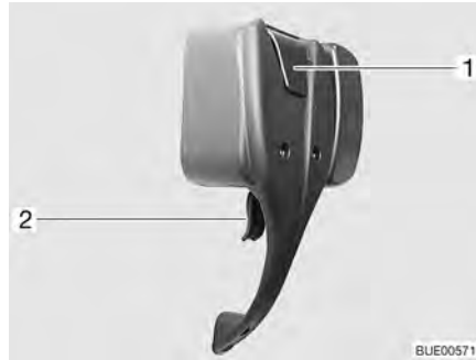
Kuva 28 Sisäänkäyntioven lukko, sisällä, lukittu
