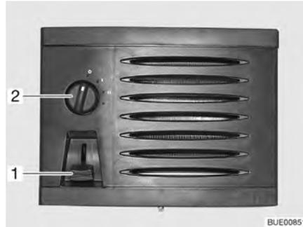
Fig. 139 Elementi di comando dello scambiatore di calore aggiuntivo
