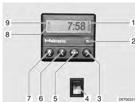
Fig. 140 Centralina di controllo per riscaldamento fisso
