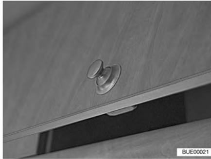
Fig. 36 Sportello del mobile con bottone automatico
