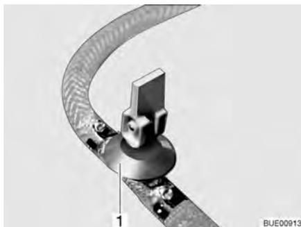
Fig. 173 Rubinetto di scarico (con leva a bilancere)
