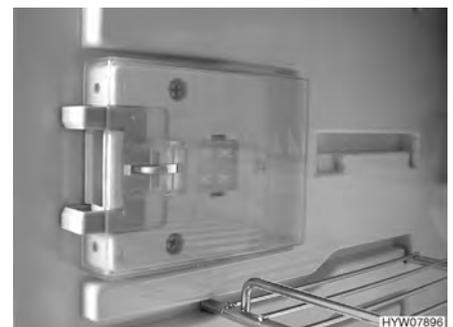
Fig. 165 Dispositivo di chiusura in posizione di ricircolo d'aria
