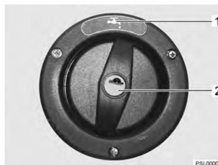
Fig. 167 Coperchio per bocchettone di riempimento dell'acqua potabile (alternativa)
