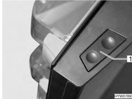
Fig. 162 Tasto di sblocco della porta del frigorifero (serie Dometic 8)
