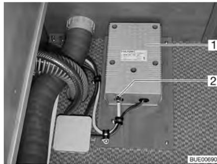
Fig. 137 Trasformatore per riscaldamento elettrico del pavimento
