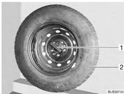
Fig. 213 Supporto per la ruota di scorta nel garage di coda
