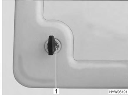
Fig. 32 Serratura a pressione sportello di servizio
