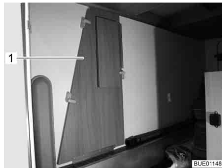
Bild 12 Bettverbreiterung in Heckgarage
