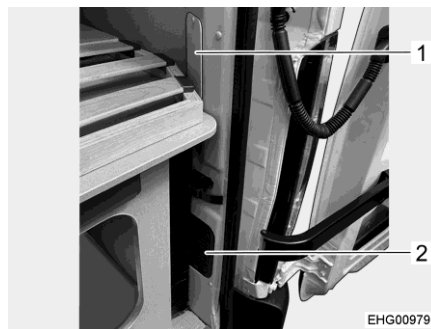
Bild 138 Åtkomst till bakljusenhetens fäste (Delfin C)
