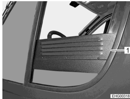
Bild 78 Ventilationsgaller (sidofönster öppet)
