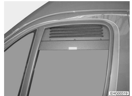
Bild 79 Ventilationsgaller (sidofönster stängt)
