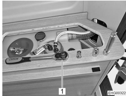
Bild 137 Åtkomst till bakljusenhetens fäste (Campeo/Eliseo)
