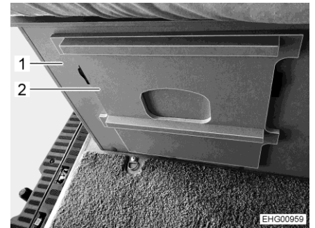
Bild 7 Skiljevägg på förvaringslådan (Delfin C)
