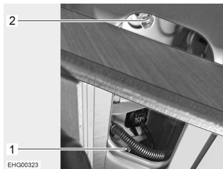
Bild 139 Fäste på bakljusenheten
