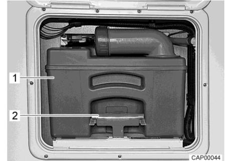
Fig. 79 Serbatoio fecale
