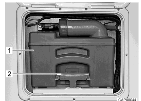
Fig. 106 Depósito de aguas fecales
