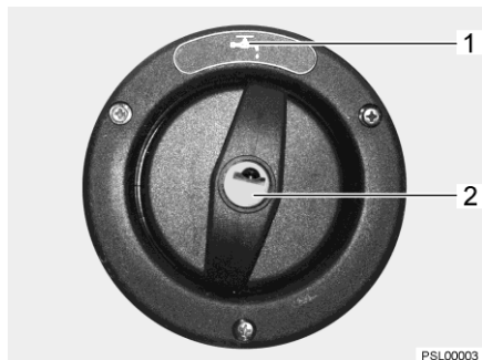
Fig. 93 Tapa de cierre para el tubo de llenado de agua potable
