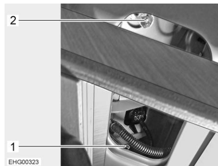
Fig. 110 Fijación de la unidad de luces traseras
