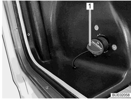
Fig. 8 Tubo de llenado para AdBlue®
