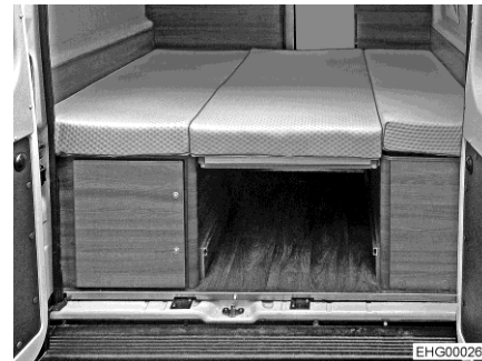
Fig. 41 Cama trasera transversal después de la transformación (variante con 3 cojines longitudinales)
