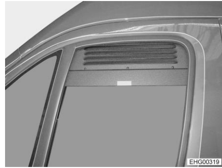
Fig. 54 Rejilla de ventilación forzada (ventana lateral cerrada)
