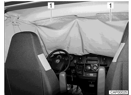
Fig. 17 Oscurecedor de la cabina del conductor en la luna delantera
