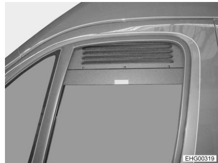
Bild 54 Ventilationsgaller (sidofönster stängt)
