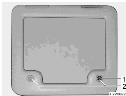
Bild 105 Lucka för latrintanken
