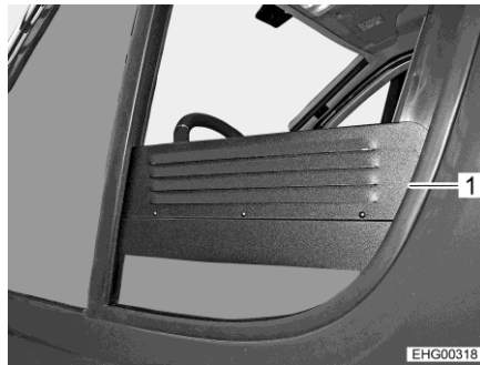
Bild 53 Ventilationsgaller (sidofönster öppet)
