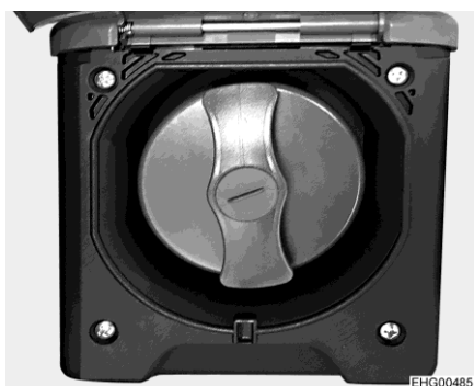
Billede 42 Dæksel til drikkevands-påfyldningsstuds
