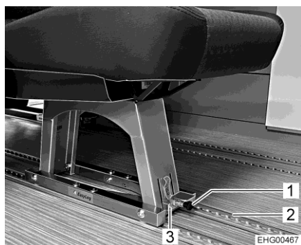
Billede 3 Enkeltstående (fastmonteret)
