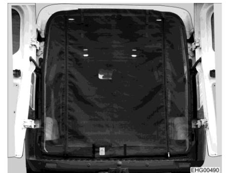
Fig. 6 Protezione contro gli insetti, in coda
