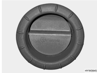
Fig. 79 Bocchetta di uscita dell'aria (riscaldamento ad aria calda)
