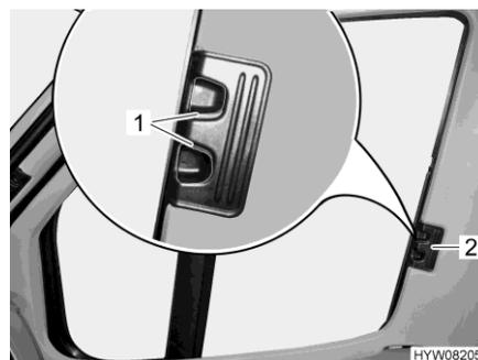
Fig. 19 Tendina oscurante pieghevole (finestrino del conducente/passeggero)
