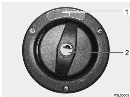
Fig. 95 Coperchio per bocchettone di riempimento dell'acqua potabile
