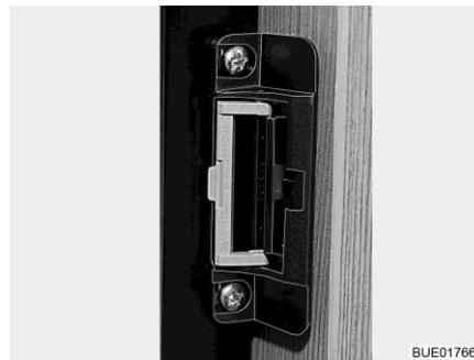
Fig. 92 Dispositivo di chiusura in posizione di ricircolo d'aria
