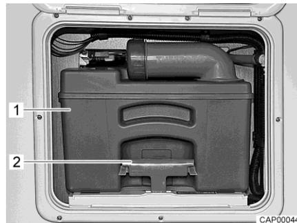
Fig. 108 Serbatoio fecale
