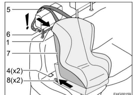
Fig. 7 Fissaggio con Isofix
