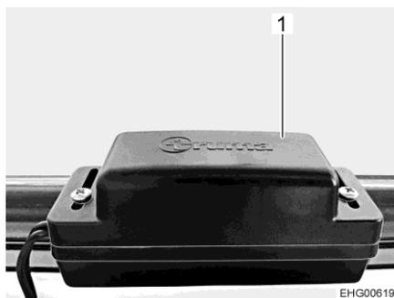
Fig. 87 Commutatore a contatto finestra
