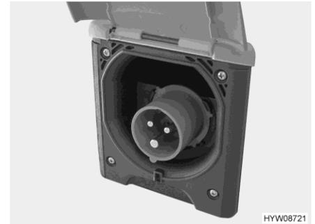
Fig. 73 Collegamento a 230 V al veicolo (presa CEE)
