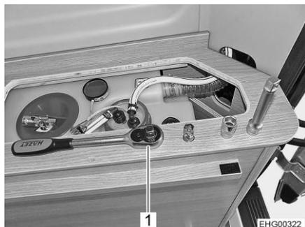
Fig. 109 Accesso al fissaggio dell'unità luci posteriori
