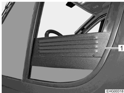
Fig. 53 Griglia di aerazione forzata (finestrino abbassato)
