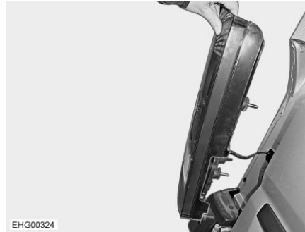
Fig. 103 Unidad de luces traseras
