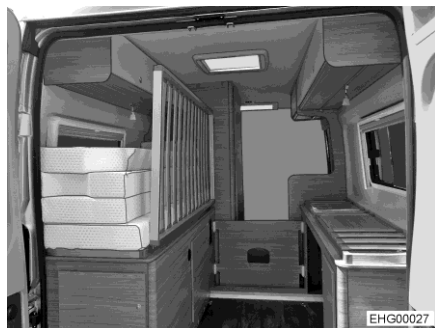
Fig. 38 Posición de transporte (somier plegable)
