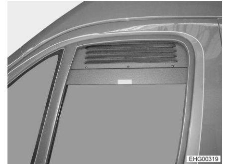
Fig. 47 Rejilla de ventilación forzada (ventana lateral cerrada)
