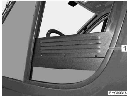
Fig. 46 Rejilla de ventilación forzada (ventana lateral abierta)
