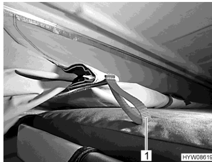
Fig. 54 Dispositivo de recogida
