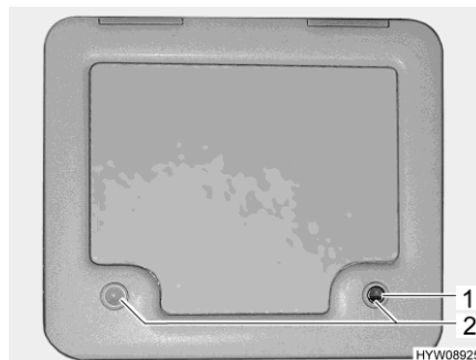
Fig. 97 Trampilla para el depósito de aguas fecales
