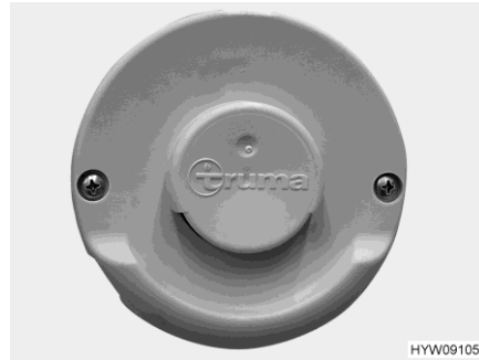
Fig. 77 Tubo de chimenea en la pared (calefacción de aire caliente)
