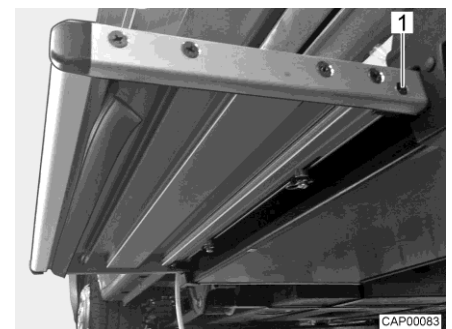
Fig. 100 Tope (escalón de entrada)
