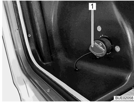
Fig. 8 Tubo de llenado para AdBlue®
