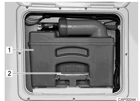
Fig. 98 Depósito de aguas fecales
