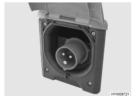
Afb. 44 230-V-aansluiting op het voertuig
