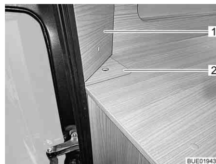
Afb. 84 Toegang tot achterlichten, links (C 640)
