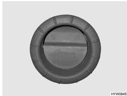
Afb. 53 Luchtuitstroomopening van de heteluchtverwarming
