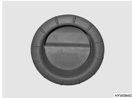
Fig. 53 Boquilla de salida de aire de la calefacción de aire caliente
