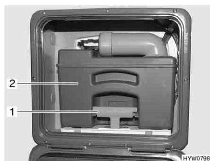
Fig. 82 Depósito de aguas fecales
