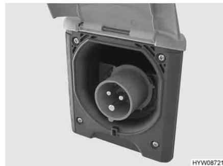
Fig. 44 Conexión de 230 V en el vehículo
