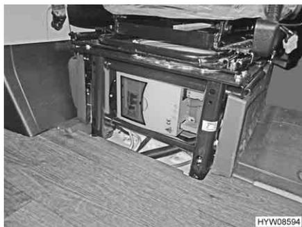
Fig. 49 Lugar de instalación de la caja de fusibles de 230 V
