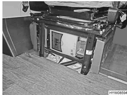
Bild 49 Einbauort 230-V-Sicherungskasten
