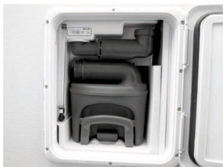
Fig. 53: Kloakktank med påfyllingsstuss for spylevann
