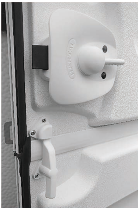
Fig. 27: Dørlås lukket, men usikret
