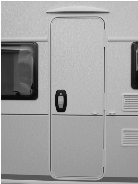
Fig. 16: Inngangsdør uten vindu (eksempel)
