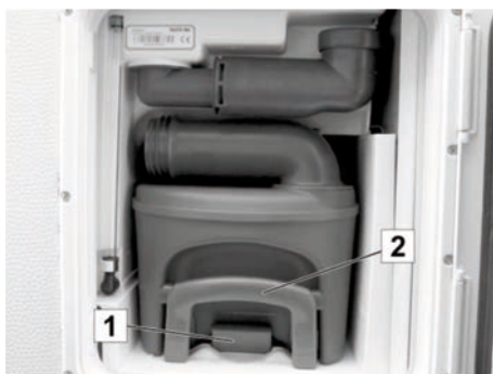
Fig. 142: Kloakktank i avfallsjakten
