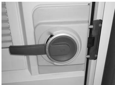
Fig. 20: Dørlås lukket, men usikret
