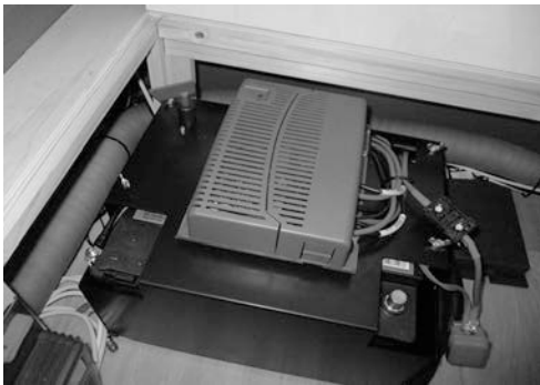
Fig. 66: Batterideksel med styreenhet for mover (ekstrautstyr)
