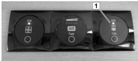
Abb. 129: Ein-/Aus-Schalter der Fußbodentemperierung
