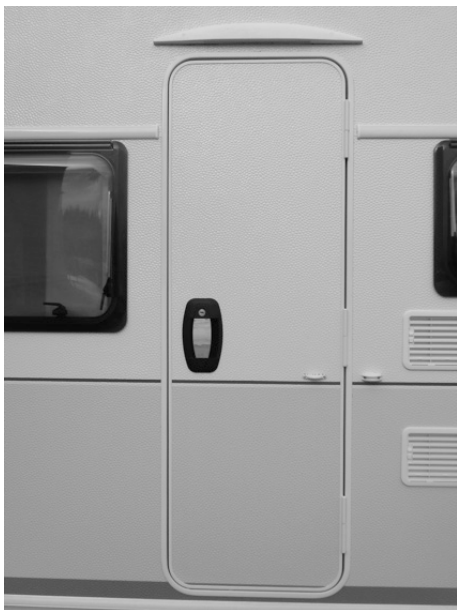
Abb. 16: Eingangstür ohne Fenster (Beispiel)
