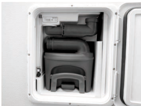
Abb. 53: Fäkalientank mit Spülwasser-Einfüllstutzen
