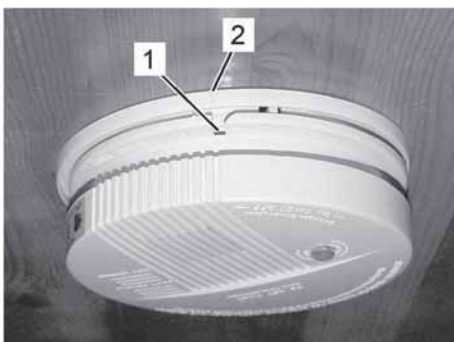
Fig. 230: Sett huset på plass
