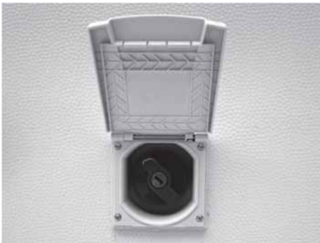
Fig. 92: Påfyllingsstuss for ferskvann
