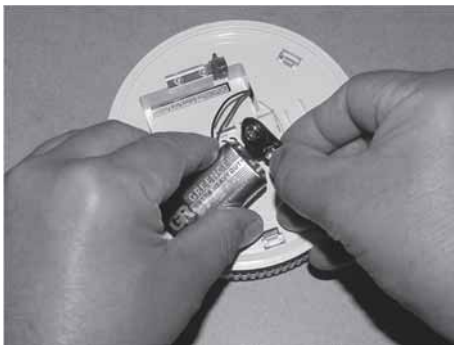
Fig. 229: Skift ut batteriet
