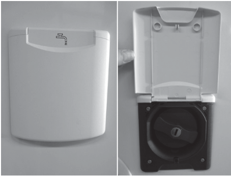
Fig. 104: Påfyllingsstuss for ferskvann
