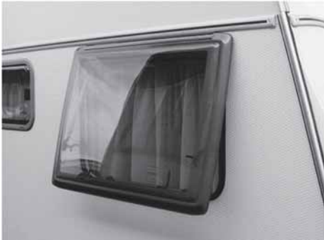
Fig. 22: Vindu som åpnes utover, med ramme
