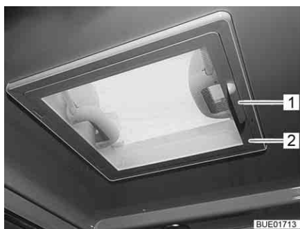
Kuva 93 Kattoluukku jossa on napsautuslukko
