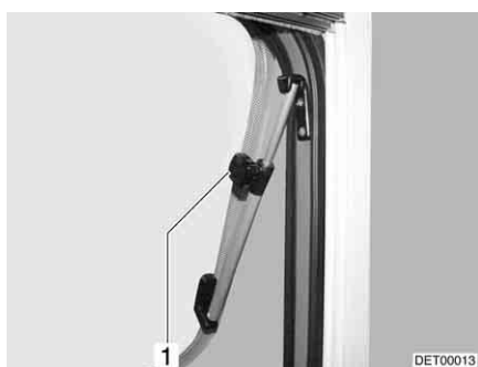
Kuva 104 Kattoluukku, jossa on kääntöpidikkeet, avattu
