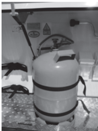
Afb. 96: Gasfles met drukvermindingsklep
