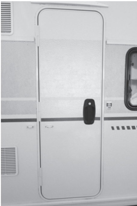
Afb. 11: Ingangsdeur zonder venster (voorbeeld)
