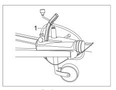
Fig. 13 Handbrake
