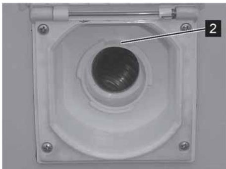
Fig. 87: Påfyldningsstuds for drikkevand, åben
