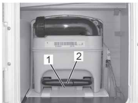
Fig. 123: Toilettank i tømmeskakten
