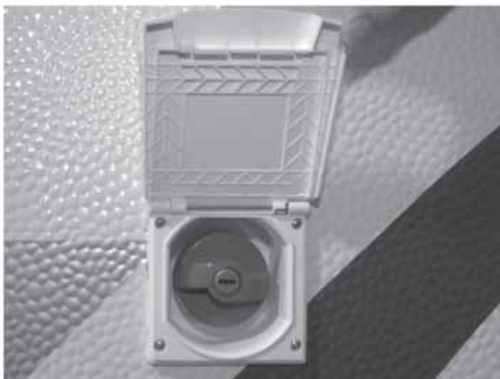
Fig. 76 : Manchon de remplissage d'eau fraîche
