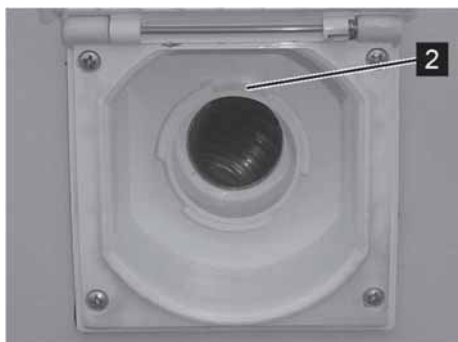
Fig. 87 : manchon de remplissage d'eau fraîche, ouvert
