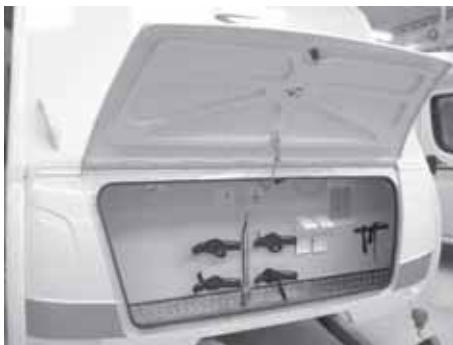
Fig. 91 : Caisson à gaz
