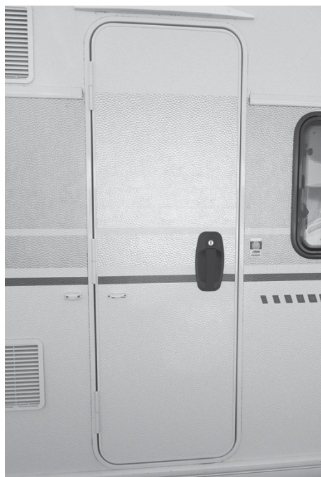
Fig. 11 : porte d'accès sans hublot (exemple)
