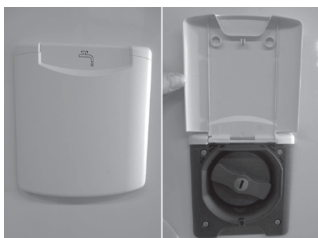
Fig. 21 : Manchon de remplissage d'eau fraîche
