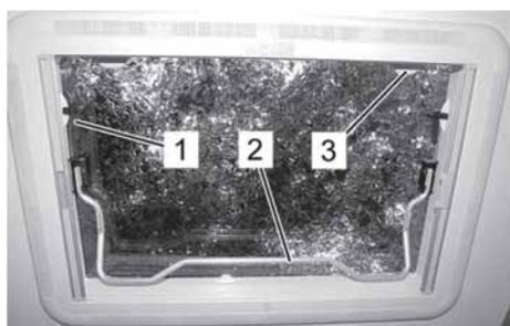
Fig. 103: Manejar el techo para elevar y girar Heki 2
