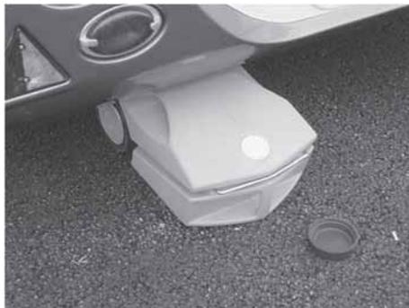
Fig. 90: Depósito de aguas residuales sobre ruedas
