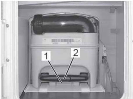
Fig. 123: Depósito de materias fecales en el pozo de eliminación
