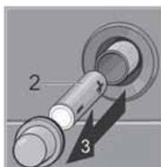
Fig. 137: Cambio de la pila en un encendedor con pila (solo si existe)
