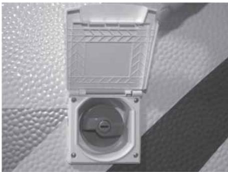
Fig. 76: Tubo de carga de agua limpia
