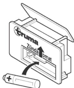
Fig. 109: Cambio de la pila
