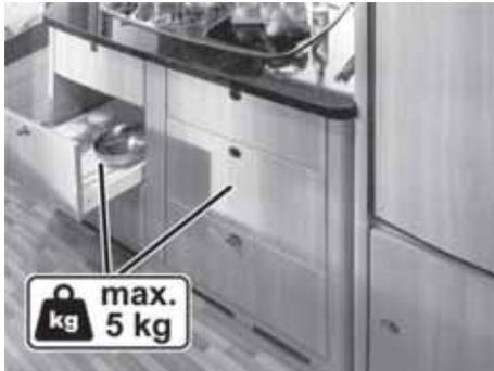
Fig. 50: Armario inferior de cocina, ejemplo
