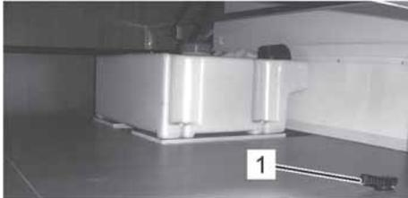
Fig. 81: Depósito de aguas residuales (opcional)
