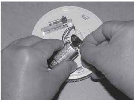
Fig. 94: Reemplazar la pila monobloc
