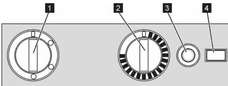
Fig. 136: Elementos de mando en la nevera con encendido manual
