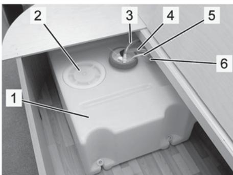
Fig. 77: Depósito de agua limpia, ejemplo
