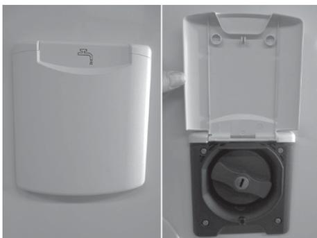
Fig. 21: Tubo de carga de agua limpia
