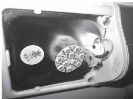
Fig. 143: Cambiar luces LED
