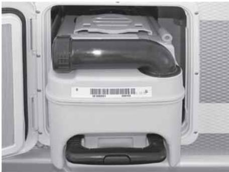
Fig. 40: Depósito para materias fecales
