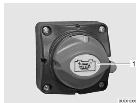
Fig. 119 Interruptor principal de la batería, posición "ON"
