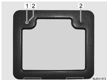
Fig. 195 Trampilla para el depósito de aguas fecales
