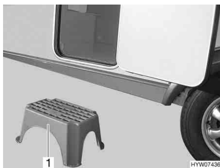
Fig. 24 Escalón de entrada (independiente)
