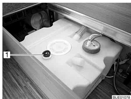
Fig. 190 Depósito de agua (40 l)
