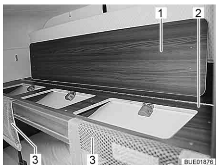
Fig. 88 Redes de seguridad y tablero insertable
