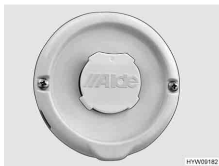
Fig. 149 Tubo de chimenea en la pared de la calefacción de agua caliente
