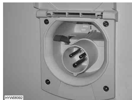
Fig. 125 Conexión de 230 V en el vehículo
