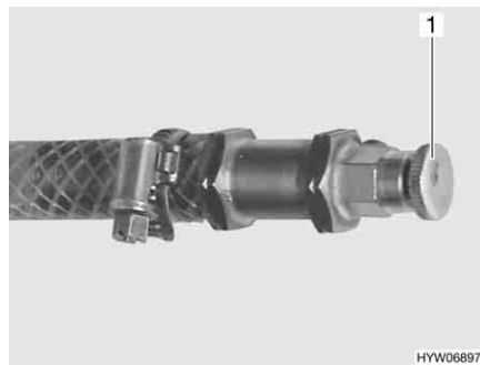
Fig. 214 Válvula de purga de la calefacción de agua caliente
