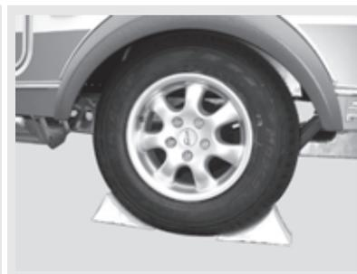
Fig. 148: Sécuriser le véhicule
