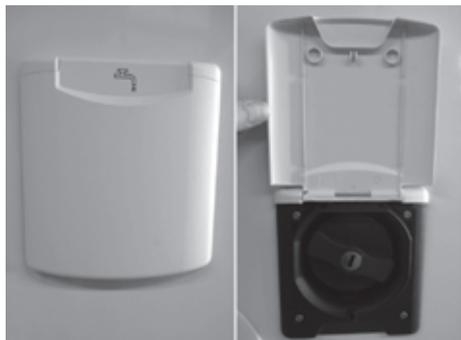
Fig. 89 : manchon de remplissage d'eau fraîche
