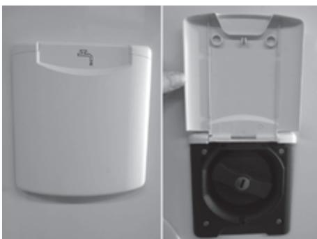
*Fig. 23 : Manchon de remplissage d'eau fraîche*
