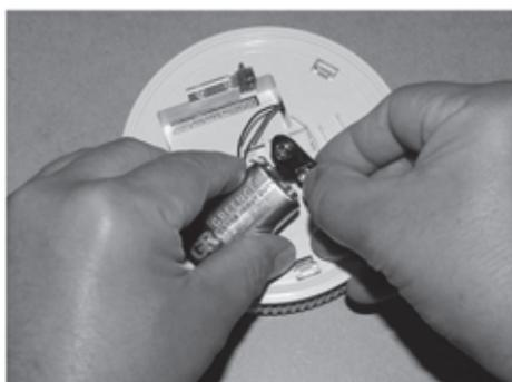
Fig. 101: Remplacer la pile
