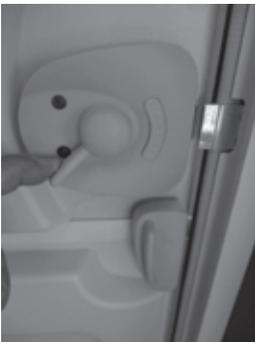
*Fig. 18 : Levier en bas, ouverture de la porte*
