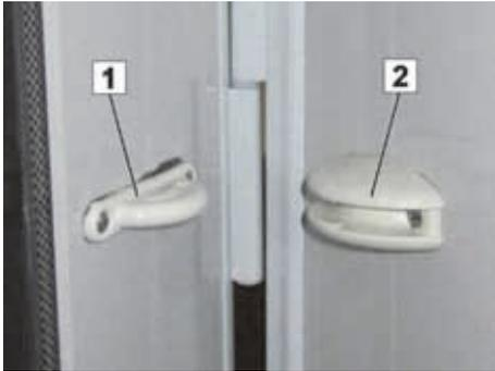
Fig. 19: Arrêteurs de portes et de trappes
