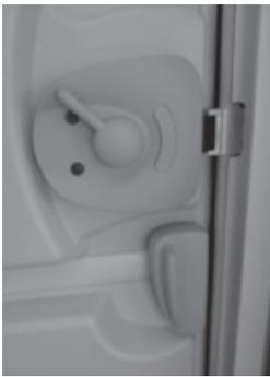
*Fig. 17 : Levier en haut, serrure de porte verrouillée*
