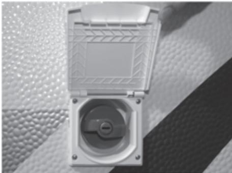
Fig. 80 : Manchon de remplissage d'eau fraîche
