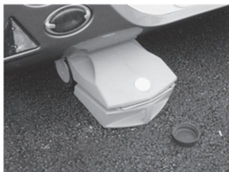
Fig. 94 : Réservoir d'eau sur roulettes
