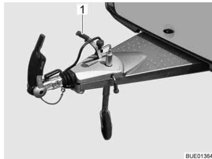
Fig. 22 Handbrake
