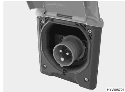
Fig. 43 Raccordement 230 V sur le véhicule (prise de courant CEE)
