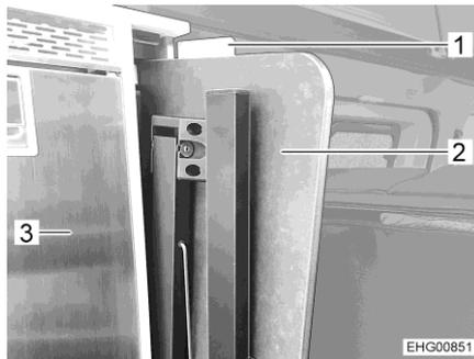
Fig. 15 Table (sécurisée dans un compartiment de rangement) (C 530)
