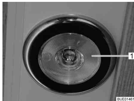
Bild 45 Einbauleuchte, Lichtschalter in der Leuchte
