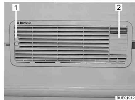
Bild 172 Kühlschrank-Lüftungsgitter (mit Einsatz für Abgasführung)
