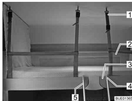
Bild 80 Hubbett mit aufgespanntem Sicherungsnetz
