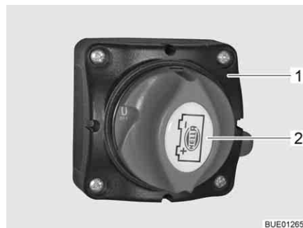
Bild 114 Batterie-Hauptschalter, Stellung "OFF"
