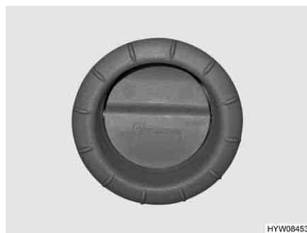
Fig. 134 Bocchetta di uscita dell'aria del riscaldamento ad aria calda
