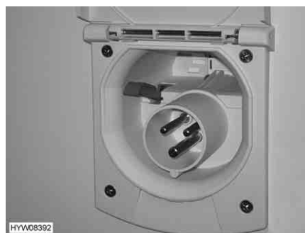
Fig. 121 Collegamento a 230 V sul veicolo
