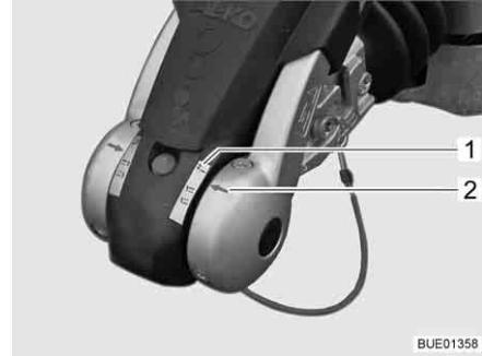
Fig. 7 Controllo "AKS chiuso"
