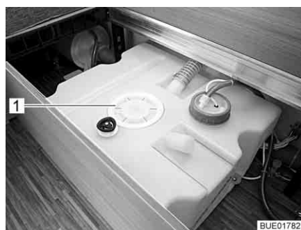
Fig. 194 Apertura per la pulizia sul serbatoio dell'acqua
