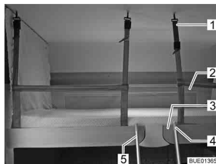
Afb. 89 Hefbed met gespannen veiligheidsnet
