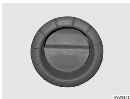
Afb. 134 Luchtuitstroomopening van de heteluchtverwarming
