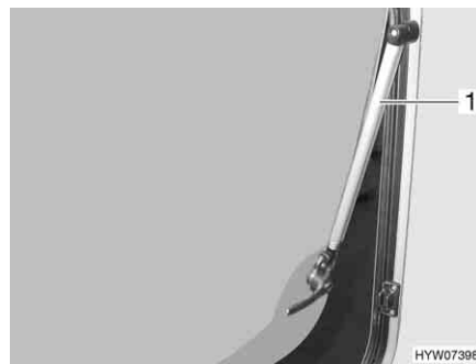
Afb. 64 Uitzetbaar raam met automatische uitzetters
