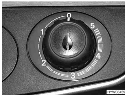
Afb. 135 Draairegelaar aan de hete- luchtverwarming
