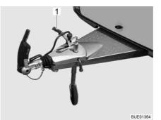
Fig. 21 Handbrake
