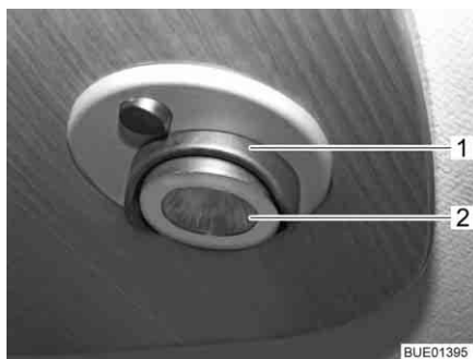
Billede 211 Indbygget halogenlampe
