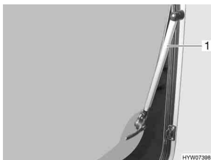
Billede 64 Ventilationsrude med automatiske udskydere
