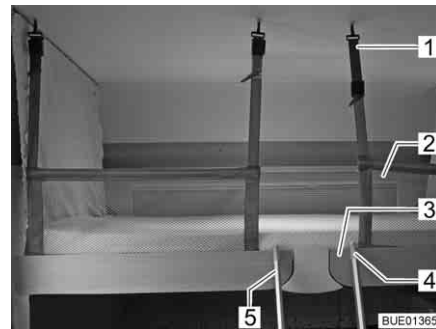
Billede 89 Hejseseng med opspændt sikkerhedsnet
