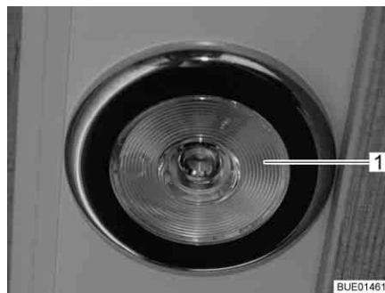
Bild 48 Infälld lampa, ljusbrytare i lampan
