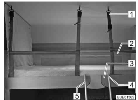
Billede 83 Hejseseng med opspændt sikkerhedsnet
