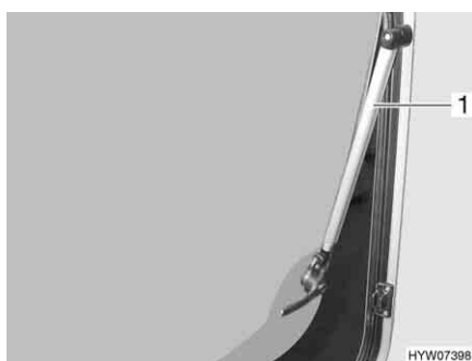
Billede 60 Ventilationsrude med automatiske udskydere
