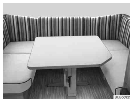
Billede 78 Efter ombygning til rundsiddegruppe
