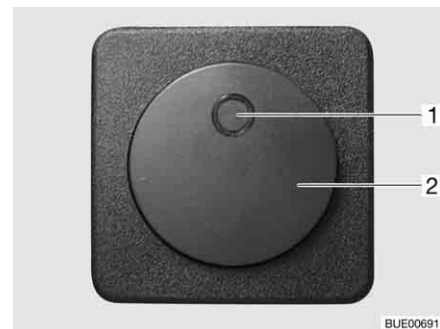
Afb. 149 Schakelaar voor de elektrische vloerverwarming
