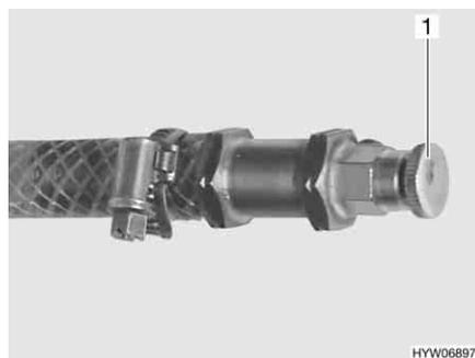
Bild 195 Entlüftungsventil Warmwasser-Heizung
