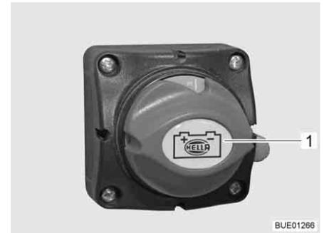
Bild 89 Batterie-Hauptschalter, Stellung "ON"
