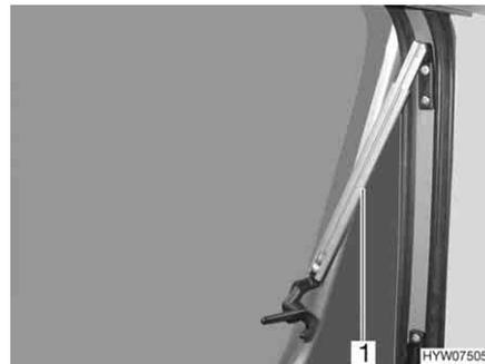
Bild 50 Ausstellfenster mit Automatik-Ausstellern, geöffnet
