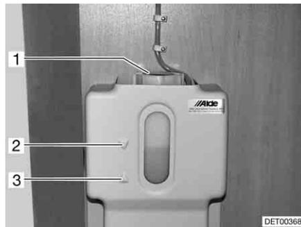
Bild 194 Ausgleichsbehälter Warmwasser-Heizung
