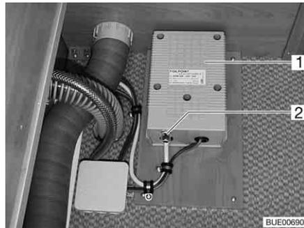
Bild 117 Trafo für elektrische Fußbodenerwärmung
