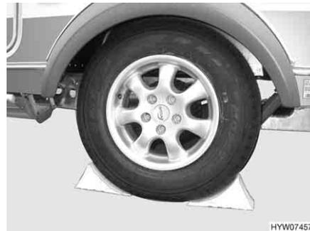
Bild 209 Fahrzeug sichern
