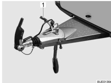
Bild 19 Feststellbremse
